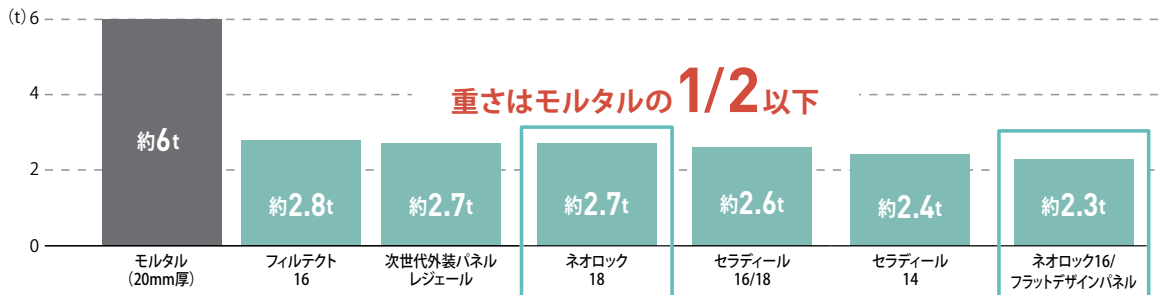
■1棟あたりの重量比較 ※1棟当たりの外壁面積を150m 2 として換算。各シリーズの最大重量で算出。
